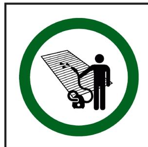
Von den tieferen Schichten und zwischen den Schienen kann Schmutz mit Hochdruckwasser ausgewaschen werden.
